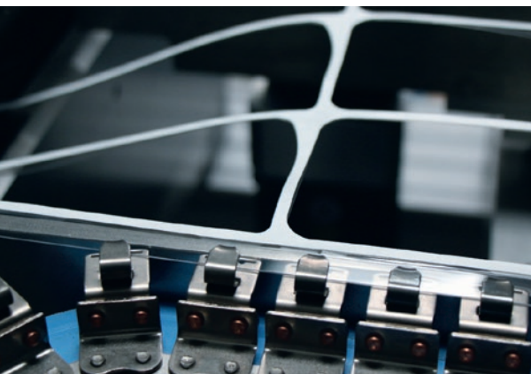
Oben: Bei der Blistermaschine KBS-KF bleibt durch die geschickte Platzierung der Blister nach der Stanzung nur wenig Material übrig.
